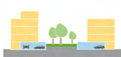
Parkeren (half) onder bebouwing
